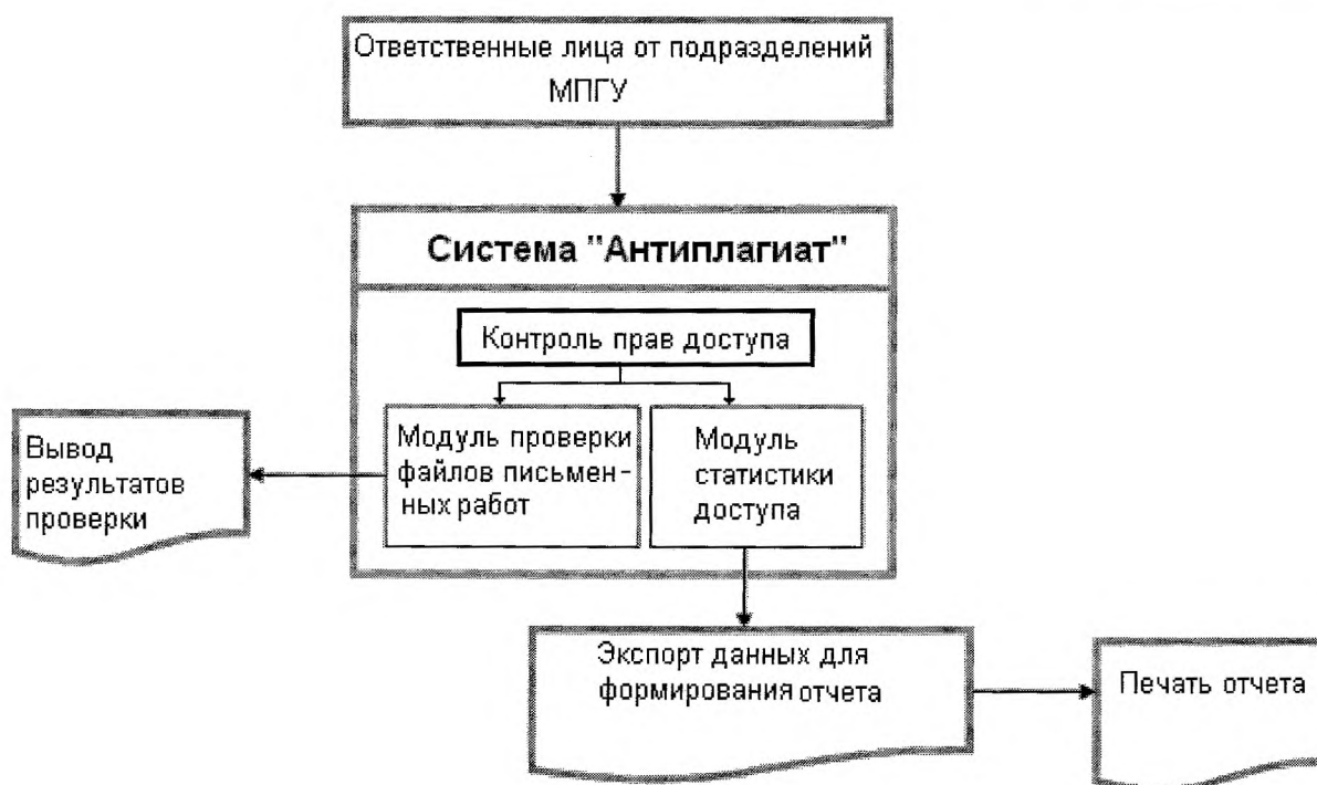
Рис. 1. Схема взаимодействия с системой «Антиплагиат»
